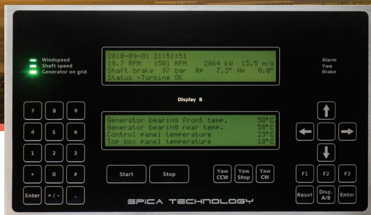
**El Controlador Spica Retrofit incluye una pantalla doble que, al tener la misma estructura que un controlador TAC, resulta muy fácil de usar y hace que el mantenimiento del aerogenerador sea más eficaz.**
